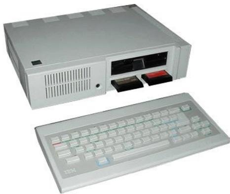
Figura 1 - IBM PCjr com teclado "chiclete" e dois cartuchos acoplados
